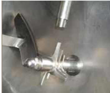
Inyectores de líquido y agitadores de alta velocidad.
